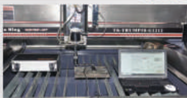
Калибровка BALLBAR (шаровой штангой)
