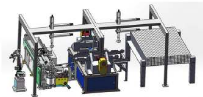
ТРУБОГИБОЧНЫЙ СТАНОК С АВТОМАТИЧЕСКОЙ РОБОТИЗИРОВАННОЙ ЗАГРУЗКОЙ И ВЫГРУЗКОЙ TH-CNC
