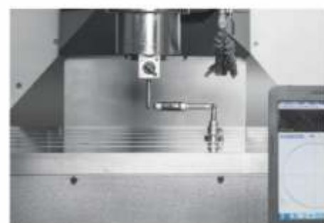
▲ Контроль с помощью щупа со сферическим наконечником на отклонение от окружности
