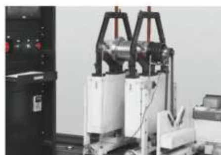
▲ Проверка динамической балансировки шпинделя
