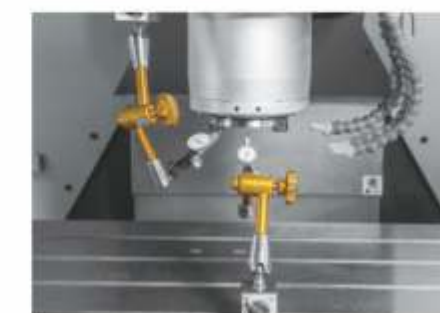
▲ Проверка удлинения шпинделя под воздействием тепла
