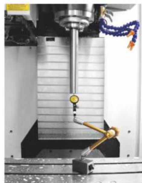
▲ Проверка шпинделя на биение
