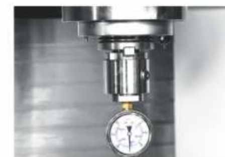
▲ Проверка натяжения шпинделя
